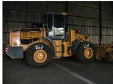
**Lote 4: PALA CARGADORA** Marca LONKING – Modelo CDM856D (Código interno CF125) – Año 2012 – Dominio CGK 79 – Motor Cummins N° 87667974 – Chasis N° F0212090574. Color amarillo. Peso operativo de 17.300 kg. Balde de 3 m³. Potencia del motor 215 Hp. En buen estado de conservación. Sin carga en la batería. (Fue señalizada LG8).
