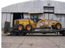
**Lote 2: MOTONIVELADORA** Marca VOLVO – Modelo G940 (Código interno MN109) – Año 2010 – Dominio CGK 01 – Motor Volvo N° 10929789 – Chasis N° VCE0G940A00502962. Articulado sobre ruedas. Color amarillo. Peso operativo 16.400 kg. En buen estado de conservación. Falta farol. Parabrisas astillado. Falta carga de batería. (Fue señalizada LG10).
